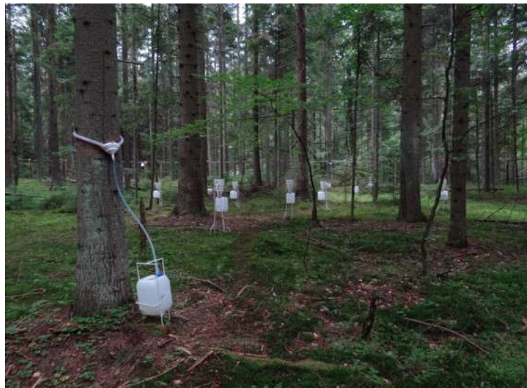
Ryc. C.2.1 Powierzchnia monitoringu chemizmu oraz ilości opadu podkoronowego (fot. P. Stachyra).
