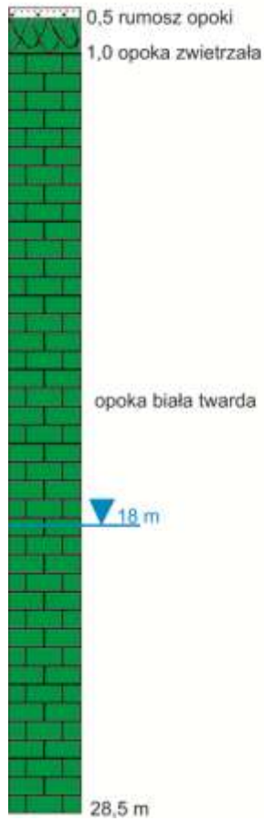
Ryc. F2.1. Profile hydrogeologiczne piezometrów opomiarowanych w zlewni Świerszcza.
