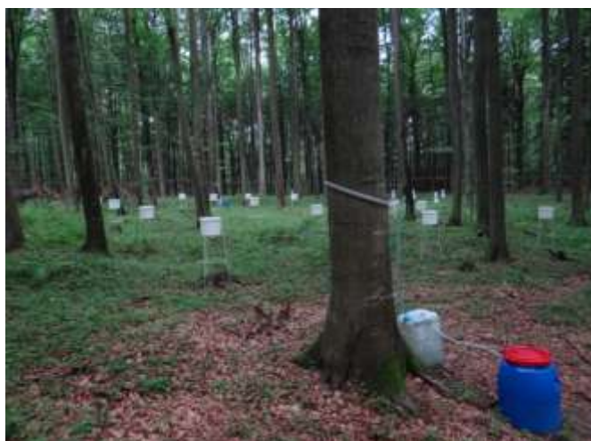
Fot. C3.1. Powierzchnia monitoringu chemizmu oraz ilości wód płynących po pniach (fot. P. Stachyra).
