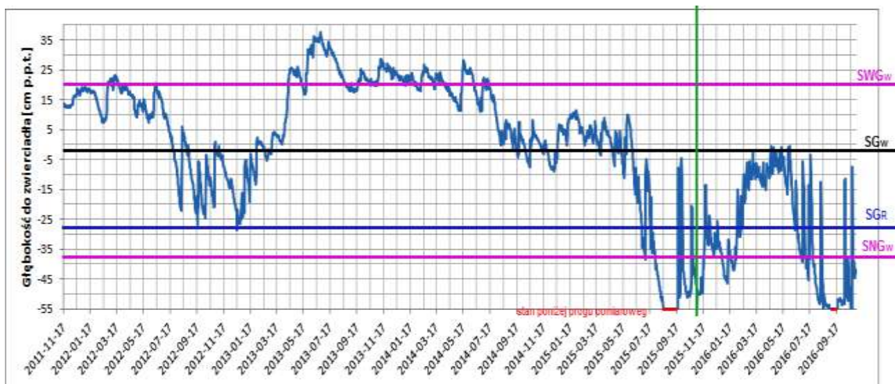
Ryc. 3.8.4. Wykresy wahań zwierciadła wody pkt pomiarowych z naniesionymi charakterystykami hydrogeologicznymi, gdzie: WG_W – średni wysoki stan wody z okresu wielolecia 2012-2015 (różowa linia); SG_W – średni średni stan (zwierciadła) wody z okresu wielolecia (czarna linia); NG_W – średni niski stan (zwierciadła) wody z okresu wielolecia (różowa linia); SG_R – średni roczny stan wody w 2016r. (linia niebieska) .
